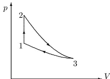
En reversibel kretsprosess utføres på  $n$  mol ideell gass:isokor ( $V = \text{konst.}$ )  $1 \rightarrow 2$ ,adiabat ( $Q = 0$ )  $2 \rightarrow 3$ ,isoterm ( $T = \text{konst.}$ )  $3 \rightarrow 1$ .Temperaturene  $T_1$  og  $T_2$  er gitt.
