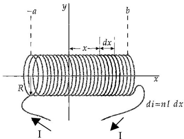
Gitt en solenoide med lengde  $L$ , radius  $R$  og  $N$  viklinger som fører en strøm  $I$ . La  $x$ -aksen være lik solenoideaksen og legg origo i avstand  $a$  fra venstre ende, som vist på figuren. Koordinaten til høyre ende blir da  $x = b = L - a$ . Vi skal studere  $B$ -feltet satt opp av solenoiden.
