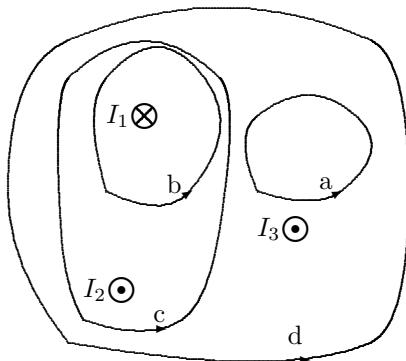
Figuren viser et tverrsnitt av flere ledere som fører strøm gjennom planet (arket) og normalt på dette. Strømmene har størrelsene  $I_1 = 4,0 \text{ A}$ ,  $I_2 = 6,0 \text{ A}$  og  $I_3 = 2,0 \text{ A}$ . Retningene er vist. Fire veier, merket a, b, c og d er markert. Retningen på veien er for alle mot klokka.
