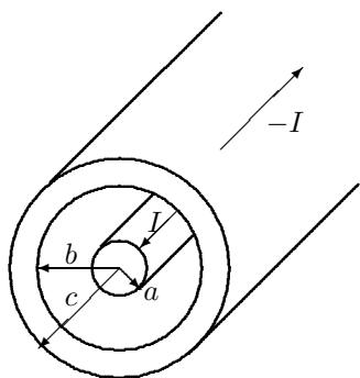
Bruk Amperes lov til å finne  $H$ -feltet i alle områder for en uendelig lang koaksialkabel som fører en strøm  $+I$  i innerleder og  $-I$  i ytterleder. Innerlederen er en massiv sylinder med radius  $a$ , ytterleder er en sylinder med innerradius  $b$  og ytterradius  $c$ . Mellom lederne er det elektrisk isolerende materiale med permittivitet  $\mu_0$ . Anta at kabelen ligger langs  $z$ -aksen og at strømmen er jamt fordelt over tverrsnittet.
