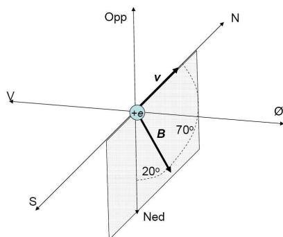
Jordas magnetfelt er et sted på jordoverflata målt til å ha en størrelse  $0,60 \text{ G}$  retta nedover og nordover med en vinkel på  $70^\circ$  med horisontalplanet som vist i figuren. (Jordas magnetfelt varierer fra sted til sted – dette er feltet som finnes sentralt i USA, i Trondheim er verdien ca  $0,50 \text{ G}$  og vinkelen litt større.)  $\text{G} = \text{gauss} = 10^{-4} \text{ T}$ .
