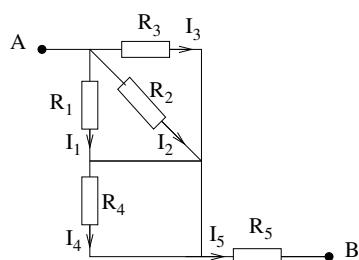
a) Bestem total motstand  $R$  mellom punktene A og B, dvs: Bestem motstanden  $R$  i den ekvivalente kretsen i følgende figur:
