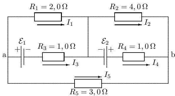
Bruk Kirchhoffs knutepunktregel og maskestrømsregel for aktuelle knutepunkt og masker i kretsen i figuren og finn verdi for strømmen  $I_5$ . Verdien på ems'ene er  $\mathcal{E}_1 = 12$  V,  $\mathcal{E}_2 = 9,0$  V med polaritet som gitt i figuren. Resistansverdiene er gitt i figuren.
