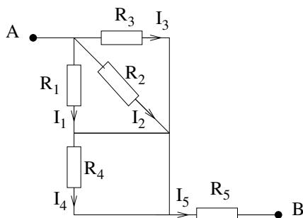
Figuren til venstre viser en elektrisk krets med 5 motstander  $R_j$ ,  $j = 1, \dots, 5$ .
