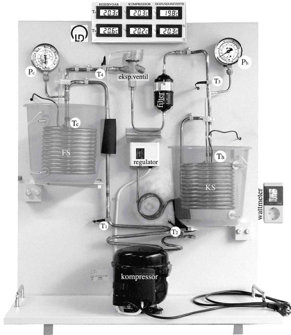
Figur 1.7: Varmepumpa. FS = fordamperspiral, KS = kondensatorspiral. De øvrige symboler er forklart i teksten.
