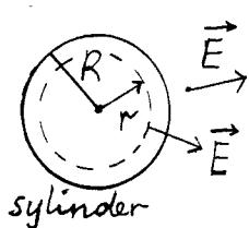
En uendlig lang massiv sylinder med radius  $R$  har en ladning  $\lambda_0$  pr. lengdeenhet. Denne ladningen er fordelt over sylinder-tverrsnittet slik at ladningstettheten er
