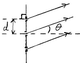
Lys faller normalt inn på et plan med 3 parallelle spalter med naboaavstand  $d$ . Lyset fra disse spaltene干涉erer ved at de 3 utsvingene  $A \cos(\omega t - \delta)$ ,  $2A \cos(\omega t)$  og  $A \cos(\omega t + \delta)$  adderes. (Merk at her er amplituden fra spalten i midten det dobbelte av amplituden fra de to andre.) Hva er fasevinkelen  $\delta$  uttrykt ved avbøyningsvinkelen  $\theta$  når lyset har frekvensen  $f$  og lyshastigheten er  $c$ ?
