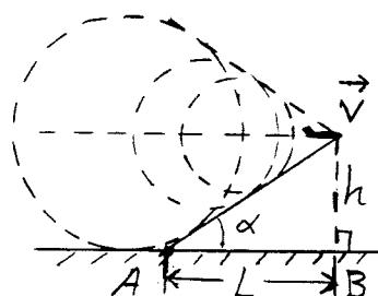
Et overlydsfly beveger seg rettlinjet og horisontalt med hastighet  $v = 1800 \text{ km/t}$  i høyden  $h = 11000 \text{ m}$  over jordoverflaten, som skissert på figuren. Sjokkbølgen treffer stedet A på jordoverflaten mens flyet befinner seg vertikalt over stedet B. Anta at lyden beveger seg med en midlere hastighet  $c = 330 \text{ m/s}$ . Hva er avstanden  $L$  mellom stedene A og B?
