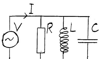
Kretsen på figuren med en motstand  $R$ , en induktans  $L$  og en kapasitans  $C$  representerer en vekselstrømkrets. Beregn forholdet
