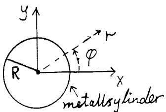
En metallsylinder med radius  $R$  plasseres i et ytre elektrisk felt som er rettet langs  $x$ -aksen. Ladninger i den ledende metallsylinderen blir da forskøvet slik at det resulterende elektriske potensialet for  $r > R$  blir
