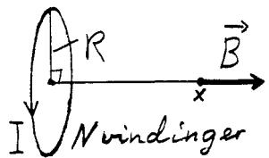
En sirkulær strømsløyfe (spole), som vist på figuren, setter opp et magnetfelt som skal bestemmes på symmetriaksen ( $x$ -aksen) gjennom sentrum av denne. Vis at i vakuum blir størrelsen av dette magnetfeltet et uttrykk av formen
