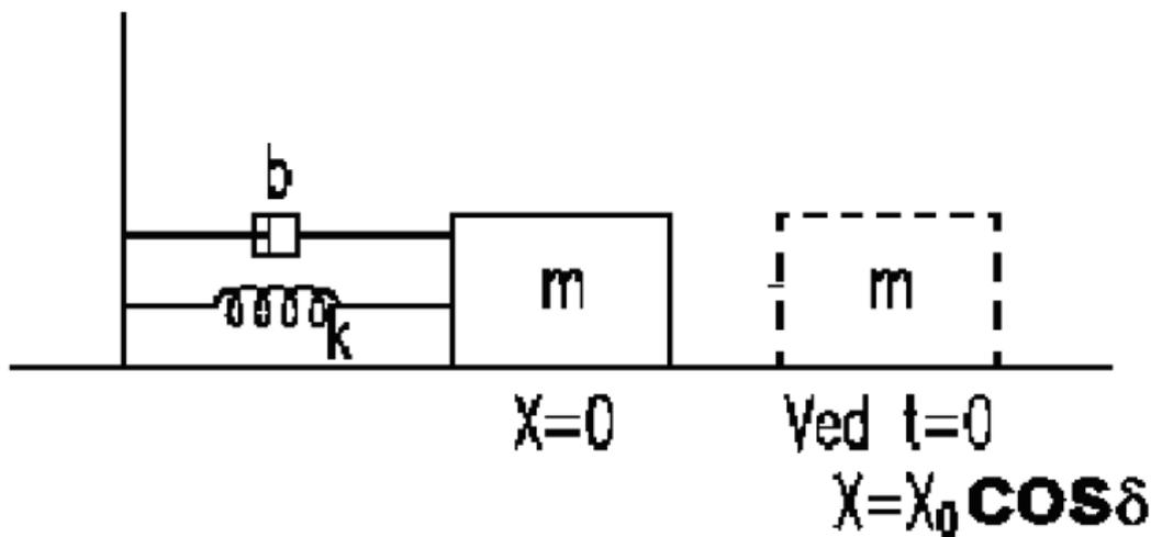
Figuren viser en kloss med masse  $m$  som beveger seg friksjonsfritt på et horisontalt underlag. Klossen er festet til en vegg med en horisontal masseløs fjær med fjærkonstant  $k$ , og i tillegg et dempeledd med lineær dempingskonstant  $b$ .
