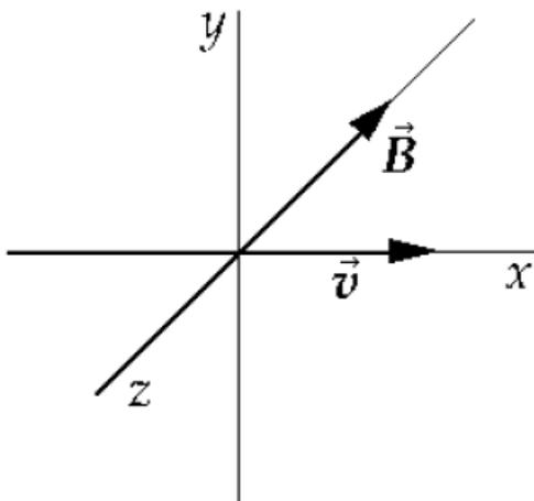
En negativt ladet partikkel beveger seg med hastighet  $v \cdot \hat{i}$  langs  $x$ -aksen. Et magnetfelt  $-B \cdot \hat{k}$  er rettet langs negativ  $z$ -akse. Du ønsker å balansere den magnetiske krafta på partiklen med et elektrisk felt, slik at partiklen beveger seg rettlinjet. Det elektriske feltet må være rettet
