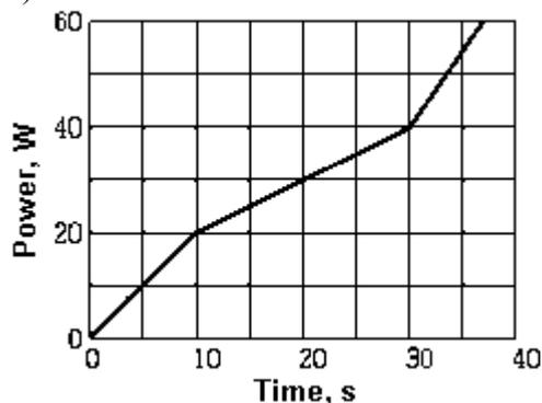
En motor yter effekt som vist i grafen. Energien som brukes av motoren i tidsintervallet fra 10 til 30 s er
