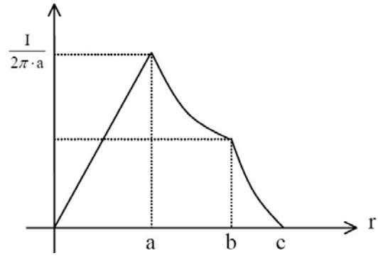
Til høyre vist skisse av  $H(r)$ . For alle  $H(r)$  er retningen asimutal:  $\vec{H}(r) = H(r)\hat{\phi}$ .
