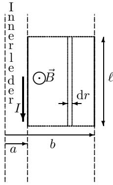
Figuren helt til venstre viser et tverrsnitt normalt på strømretningen. Arealet som er aktuelt for å beregne asimutal fluks blir et rektangel med sidekanter langs henholdsvis radius (kortstiplet linje) og i kabelretningen. Dette rektangelet med bredde  $b - a$  og høyde  $\ell$  er vist i høyre figur.
