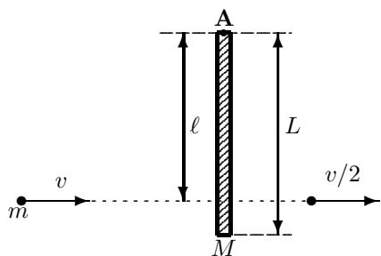
Figuren viser en tynn, homogen stav med masse  $M$  og lengde  $L$  som kan rotere friksjonsfritt om en fast horisontal akse  $A$  (som står normalt på staven/papirplanet). Staven henger i ro vertikalt.
