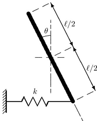
En tynn, uniform metallstav med masse  $M$  er hengt opp uten friksjon om en akse gjennom stavens midtpunkt og loddrett på staven. Den nederste enden av staven er festet til ei horisontal fjær med fjærkonstant  $k$  (fjærkraft  $F = -kx$ ). Fjæras andre ende holdes i ro.
