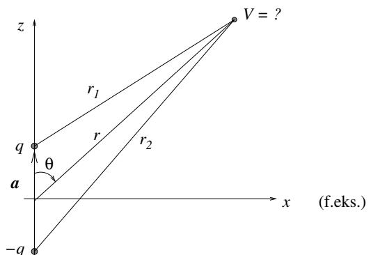
Siden vi her opplagt må ha *symmetri* med hensyn til rotasjon omkring  $z$ -aksen, er det tilstrekkelig å se på forholdene i et halvplan som inneholder  $z$ -aksen, f.eks.  $xz$ -planet, med  $x > 0$ .
