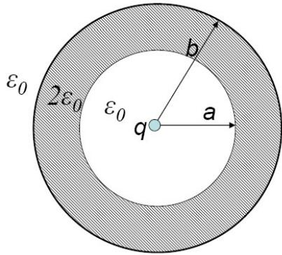
Et elektrisk nøytralt dielektrikum med permittivitet  $\epsilon = 2\epsilon_0$  fyller et kuleskall med innre radius  $a$  og ytre radius  $b$ . I sentrum av hulrommet inni kuleskallet er det plassert en punktladning  $q$ . Rommet forøvrig består av luft (vakuum).
