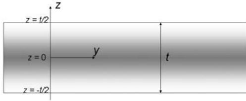
Figuren viser tverrsnitt av ei dielektrisk (elektrisk isolerende) plate med permittivitet  $\epsilon$ , total tykkelse  $t$  i  $z$ -retningen og uendelig utstrekning i  $x$ - og  $y$ -retningene. Plata har romladningstetthet gitt ved
