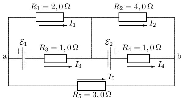
Bruk Kirchhoffs knutepunktregel og maskestrømsregel for aktuelle knutepunkt og masker i kretsen i figuren og finn verdi for strømmen  $I_5$ . Verdien på ems'ene er  $\mathcal{E}_1 = 12 \text{ V}$ ,  $\mathcal{E}_2 = 9,0 \text{ V}$  med polaritet som gitt i figuren. Resistansverdiene er gitt i figuren.
