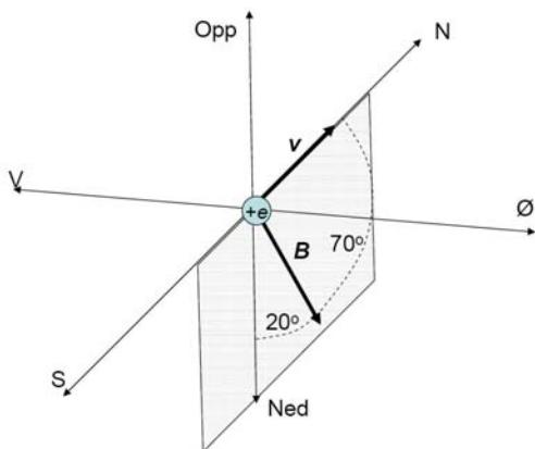
Jordas magnetfelt er et sted på jordoverflata målt til å ha en størrelse 0,60 G retta nedover og nordover med en vinkel på  $70^\circ$  med horizontalplanet som vist i figuren. (Jordas magnetfelt varierer fra sted til sted – dette er feltet som finnes sentralt i USA, i Trondheim er verdien ca 0,50 G og vinkelen litt større.) G = gauss =  $10^{-4}$  T.
