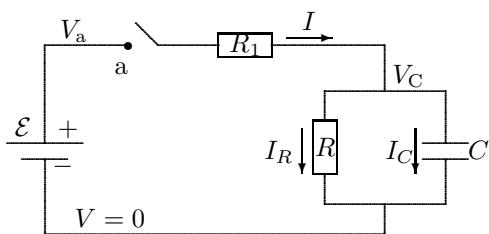
I kretsen i figuren settes bryteren i posisjon *a* ved tida  $t = 0$ . La spenninger og strømmer være som angitt i figuren. Kondensatoren har til enhver tid ladningen  $Q_C(t)$ . Ved  $t < 0$  er  $V_C = 0$  og dermed alle strømmer lik null (og  $V_a = \mathcal{E}$ ).
