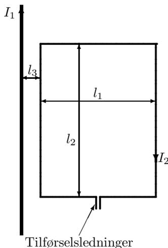
Figuren viser en svært lang, rett ledning som fører en strøm  $I_1 = 50$  A i retning oppover. I avstand  $l_3 = 1,00$  cm er plassert en rektangulær strømsløyfe med to sidekanter med lengde  $l_2 = 20$  cm og to sidekanter med lengde  $l_1 = 8,0$  cm. Den lengste sidekanten er parallell med den rette ledningen. Strømsløyfa fører en strøm  $I_2 = 10,0$  A i retning med klokka.
