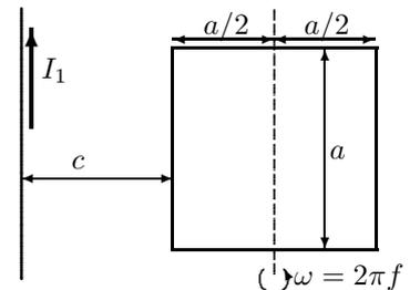
Finn uttrykk for induisert elektromotorisk spenning i ledersløyfa. Sett inn tallsvar med oppgitte tallverdier:  $a = 0,100$  m,  $c = 1,00$  m,  $I_1 = 50$  A,  $f = 1,00$  kHz.
