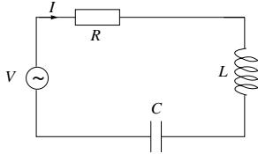
Figuren viser en resonanskrets, i form av en seriekobling av  $R$ ,  $C$  og  $L$ . Det er resonans i kretsen ved den frekvensen der strømamplituden er maksimal, dvs.  $|Z|$  er minimum.
