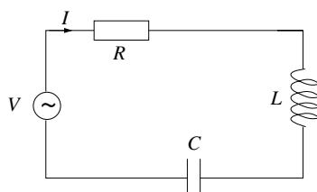
Figuren viser en resonanskrets, i form av en seriekobling av  $R$ ,  $C$  og  $L$ . Det er resonans i kretsen ved den frekvensen der strømamplittuden er maksimal, dvs.  $|Z|$  er minimum.
