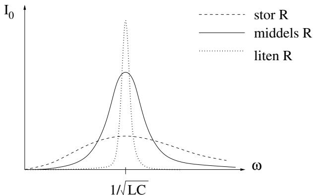
Figuren viser hvordan  $|I_0|$  varierer med  $\omega$  ifølge likn. (10) for hhv. stor, middels og liten verdi for resistansen  $R$ . Ved  $\omega = \omega_0$  får vi maksimal amplitude på strømmen med  $|I_0| = |V_0|/R$ . Vi har da *resonans*. Frekvensen til den påtrykte spenningen "matcher" da den elektriske kretsens "naturlige frekvens"  $\omega_0$ .
