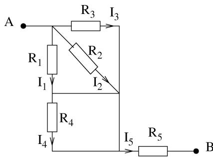
Figuren til venstre viser en elektrisk krets med 5 motstander  $R_j$ ,  $j = 1, \dots, 5$ .
