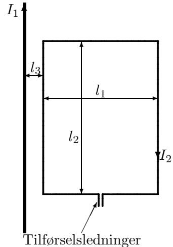
Figuren viser en svært lang, rett ledning som fører en strøm  $I_1 = 50$  A i retning oppover. I avstand  $\ell_3 = 1,00$  cm er plassert en rektangulær strømsløyfe med to sidekanter med lengde  $\ell_2 = 20$  cm og to sidekanter med lengde  $\ell_1 = 8,0$  cm. Den lengste sidekanten er parallel med den rette ledningen. Strømsløyfa fører en strøm  $I_2 = 10,0$  A i retning med klokka.
