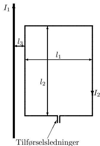
Figuren viser en svært lang, rett ledning som fører en strøm  $I_1 = 50 \text{ A}$  i retning oppover. I avstand  $\ell_3 = 1,00 \text{ cm}$  er plassert en rektangulær strømsløyfe med to sidekanter med lengde  $\ell_2 = 20 \text{ cm}$  og to sidekanter med lengde  $\ell_1 = 8,0 \text{ cm}$ . Den lengste sidekanten er parallel med den rette ledningen. Strømsløyfa fører en strøm  $I_2 = 10,0 \text{ A}$  i retning med klokka.
