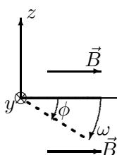
En kvadratisk ledersløyfe med sidekant  $L$ , masse  $m$  og total resistans  $R$  ligger i horisontalplanet  $xy$  med et hjørne i origo, en sidekant langs  $x$ -aksen og en sidekant langs  $y$ -aksen, se figuren.
