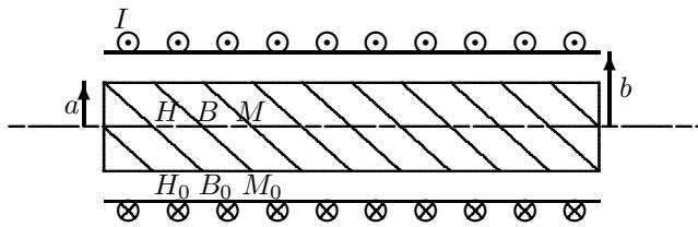
En cylinderformet stav av jern med relativ permeabilitet  $\mu_r = 2000$  er plassert midt (koaksialt) inne i en solenoide. Innerradien til solenoiden er  $b = 30$  mm og radien til staven er  $a = 15$  mm. Viklingstallet for solenoiden er  $n = 900 \text{ m}^{-1}$  og den fører en strøm  $I = 3,00 \text{ A}$ . Du kan anta både solenoiden og staven er svært lange slik at du kan se bort fra randeffekter.
