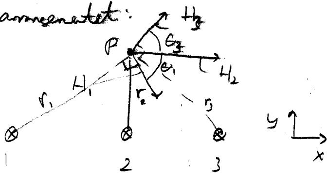
Nunne ledene 1, 2. og 3.  $H_1$ ,  $H_2$ , og  $H_3$  er magnetfeltet i P satt opp av disse tre ledene ( $H_i$  fra 1. osv)
