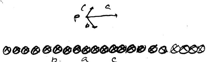
Bidrag til magnetisk feltstyrke i punkt p: For leder plassert under normalen:  $\vec{H} \parallel$  planet.
