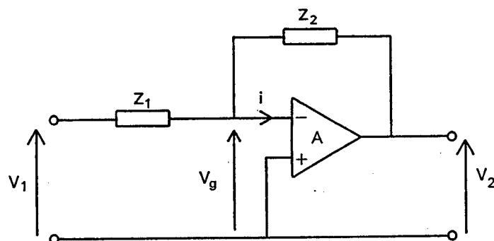
Hvis vi bruker innspenningen  $V_g$  og utgangen  $V_2$  som henholdsvis inn- og utgangssignal, så blir overføringsfunksjonen:
