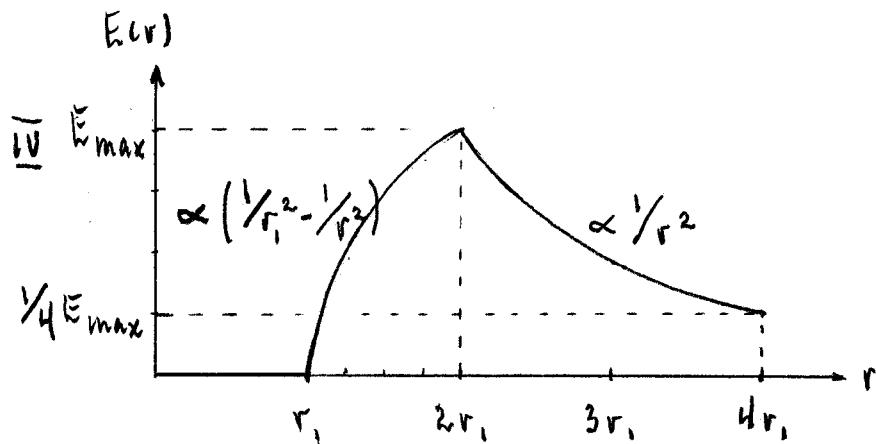
Max. omstuttit fri ladning :  $Q$  for  $r = r_2 = 2r_1$
