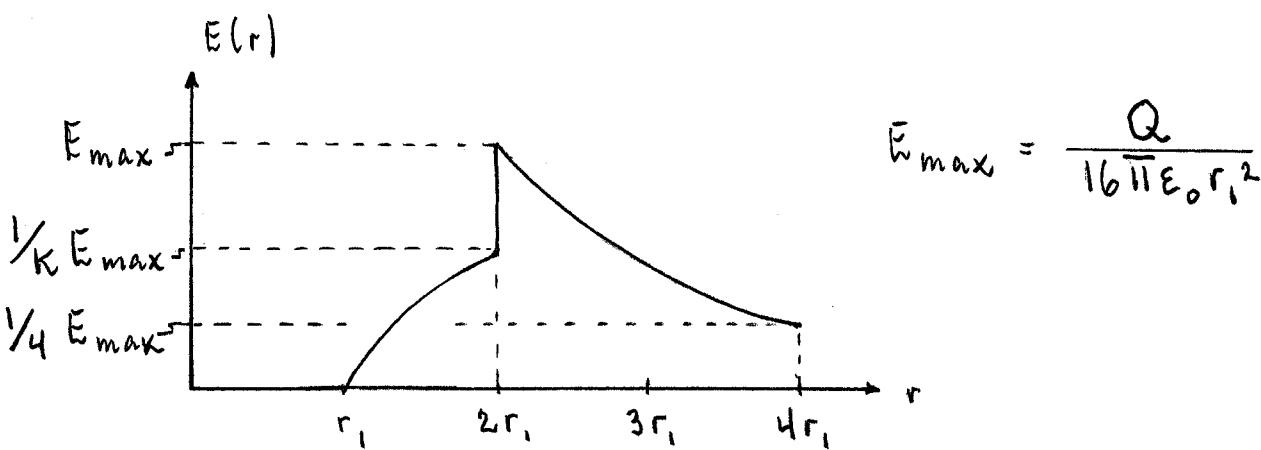
Pga. den inducerade overflätsladningen vid  $r = 2r_1$ , vil  $E(r)$  ska i st sprang i detta siktet. För  $r > 2r_1$ , är förlopet av  $E(r)$  mindre.
