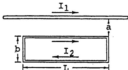
Gjennom en lang ledning fiksert i rommet går en strøm  $I_1$ . En strøm  $I_2$  går gjennom en rektangulær strømsløyfe. Strømretninger, dimensjoner og avstander er gitt i figuren. Hva er det riktige uttrykket for resultantkraften som virker på strømsløyfa? Svar også på om netto kraft er attraktiv eller repulsiv.
