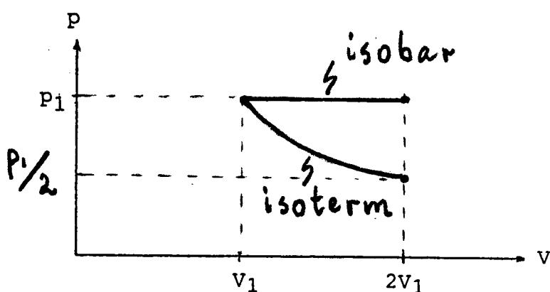
14. Beregn arbeidet som gassen i pkt. 13 utfører på omgivelsene i de to tilfellene,  $W_{\text{isobar}}$  og  $W_{\text{isoterm}}$ , og bestem forholdet  $W_{\text{isobar}}/W_{\text{isoterm}}$ .
