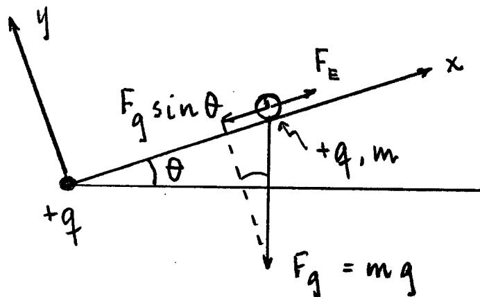
16. For systemet i pkt. 15 er verdiene:  $\theta = 6^\circ$ ,  $m = 0.4\text{ g}$  og likevektsavstanden  $\ell = 9\text{ cm}$ . Hvor stor er ladningen  $q$  (C)?
