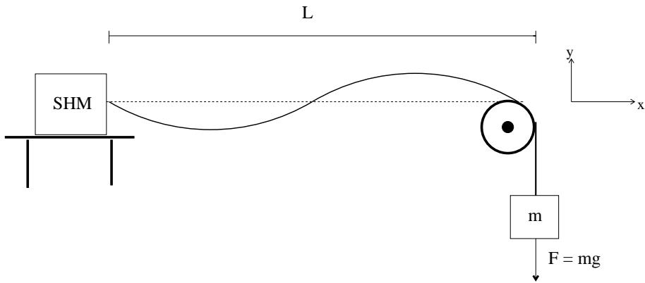
I den ene enden av strengen er det en bølgekilde, betegnet SHM (“Simple Harmonic Oscillator”) i figuren, som genererer harmoniske bølger på strengen med frekvens  $f$ . I den andre enden går strengen over en trinse, og er festet i et lodd med masse  $m$ . Strengens lengde er  $L$  og den har massetetthet  $\mu$ . Følgende størrelser antas kjent i denne oppgaven:  $L, m, g, f, \mu$ .
