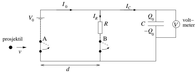
Spenningskilden  $V_0$  er koblet til en kondensator med kapasitans  $C$  og en motstand med resistans  $R$  som vist i figuren. Et voltmeter ( $V$ ) måler spenningen over  $C$ . Det går en stasjonær (dvs tidsuavhengig) strøm i det skuddet avfyres. Ved tidspunktet  $t = 0$  treffer prosjektilet bryteren  $A$  slik at spenningskilden kobles ut:
