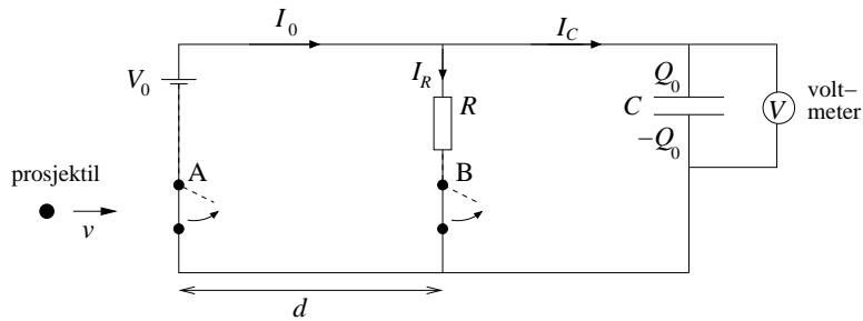
Spenningskjelda  $V_0$  er kopla til ein kondensator med kapasitans  $C$  og ein motstand med resistans  $R$  som synt i figuren. Eit voltmeter ( $V$ ) måler spenninga over  $C$ . Det går ein stasjonær (dvs tidsuavhengig) straum i krinsen i det skuddet vert avfyrt. Ved tidspunktet  $t = 0$  treffer prosjektilet brytaren  $A$  slik at spenningskjelda vert kopla ut:
