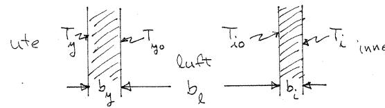
Temperaturene på inn- og utsiden av innerveggen er  $T_i$  og  $T_{i0}$ . Temperaturene på ut- og innsiden av ytterveggen er  $T_y$  og  $T_{y0}$ . I første omgang negligerer vi konveksjonseffekter.
