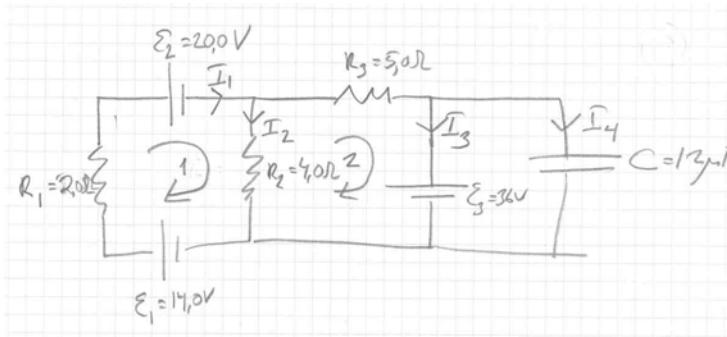
Strømmen  $I_4$  gjennom kondensatoren er null når kondensatoren er fullt oppladet,  $\underline{I_4=0}$
