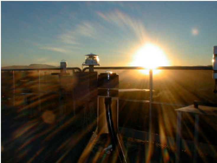
Figur: Instrumentering for måling av UV stråling på taket av Realfagbygget, solplattformen
