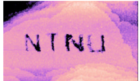
Figuren viser bokstavene NTNU ”skrevet” med STM i SrRuO 3 . Linjene er ca. 10 nm brede.
