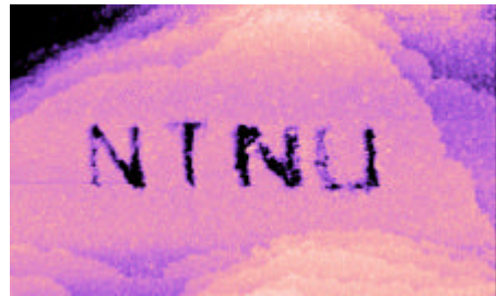
Figuren viser bokstavene NTNU "skrevet" med STM i \text{SrRuO}_3 . Linjene er ca. 10 nm brede.
