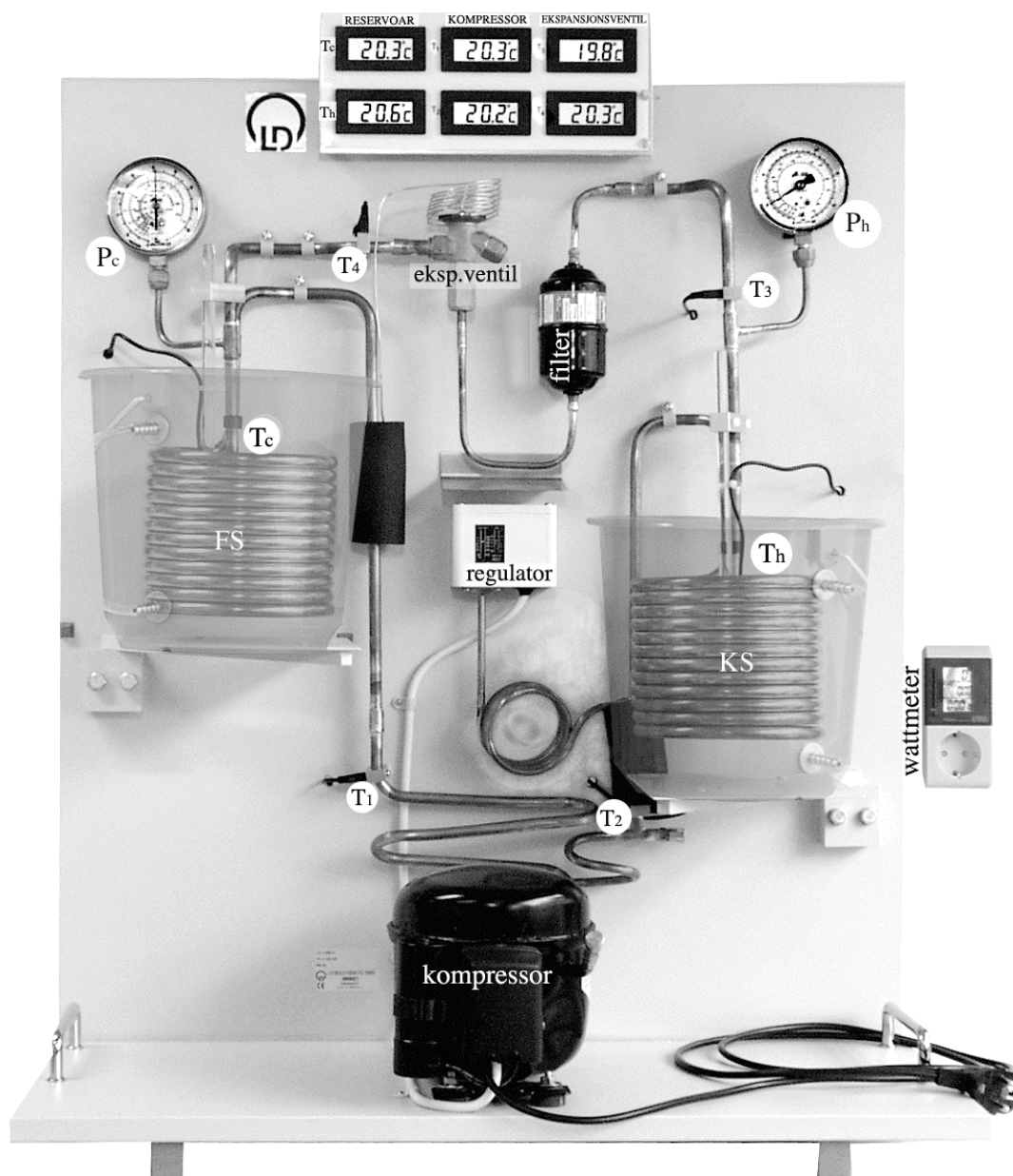
Figur 6 Apparatur for varmepumpeforsøket.
